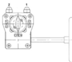
Редуктор в положении «ЗАКРЫТО» – ось указателя перпендикулярна оси крана (A)
